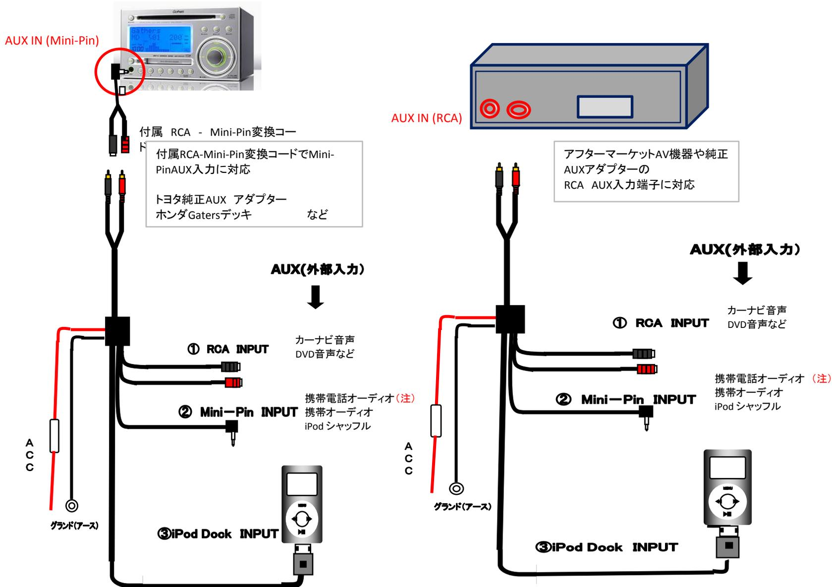
主機能 ■3種類の入力端子 (RCA, Mini-Pin, iPod Dock), 2種類の主力端子 (RCA, Mini-Pin)
